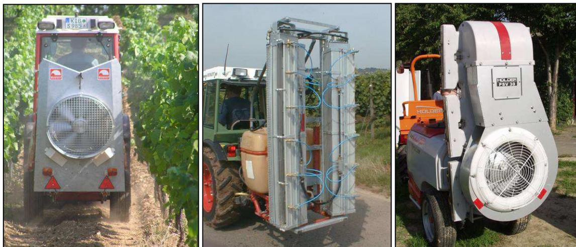
Abbildung 67: Axialgebläse mit Luftleitsystem (links), Tangentialgebläse (Mitte), Diffusor-Radialgebläse (rechts)
